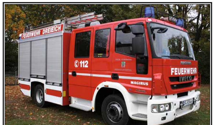
Iveco Magirus: 14 Tonnen Straßen-Fahrgestell mit AluFire3 Feuerwehraufbau. 6-Zylinder Diesel mit 185 kW (251 PS)
